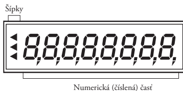
Obrázok 2.7 – Rozdelenie 7-segmentového LCD displeja
